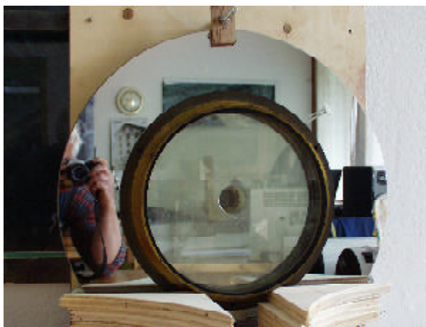
foto n. 3 l'obiettivo posto davanti al piano di controllo per l'autocollimazione.
