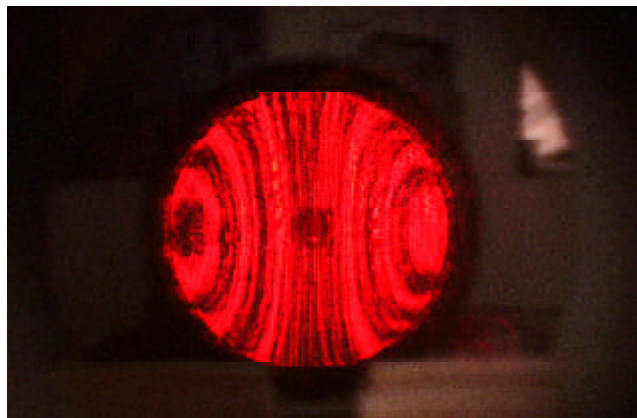
foto n.4 forte sottocorrezione sferica, il disco nero al centro è dovuto al foro centrale del piano di controllo.
